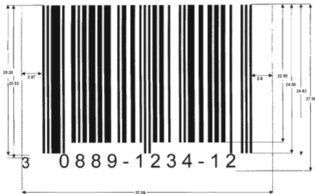
Рисунок Е.3 — Пример вариации символа UPC-A
