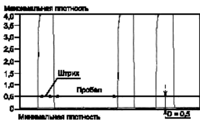
Рисунок А.3 — Точка порога для определения края штриха
