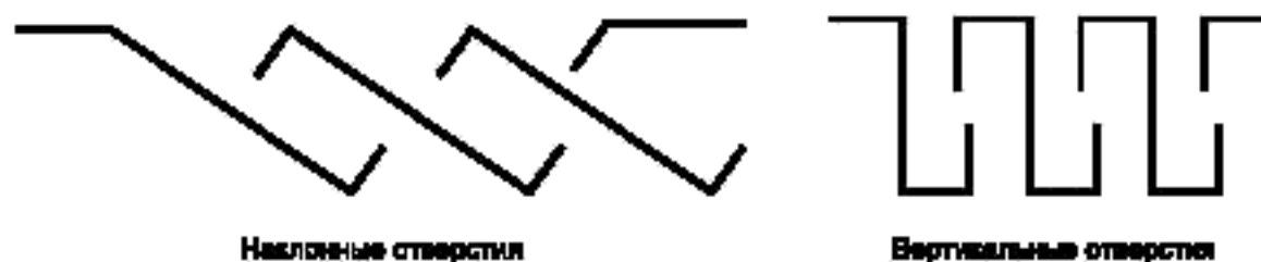
Рисунок 4В — Примеры поперечного сечения конструкции отверстий
