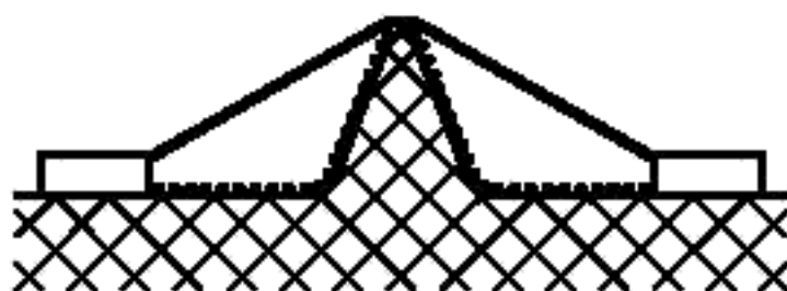
Рисунок F.3 — V-образная канавка
