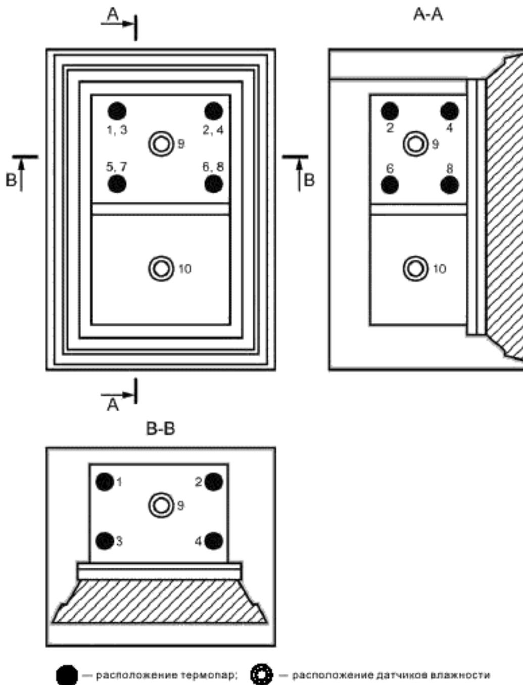
Рисунок 6 — Точки измерений (1—10) в испытываемых образцах контейнеров данных
