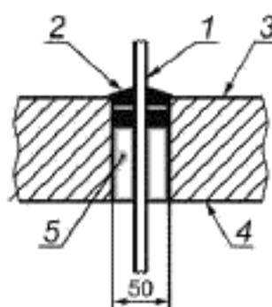
1 — кабель контрольно-измерительных приборов; 2 — силикон; 3 — внутренняя сторона; 4 — внешняя сторона;
