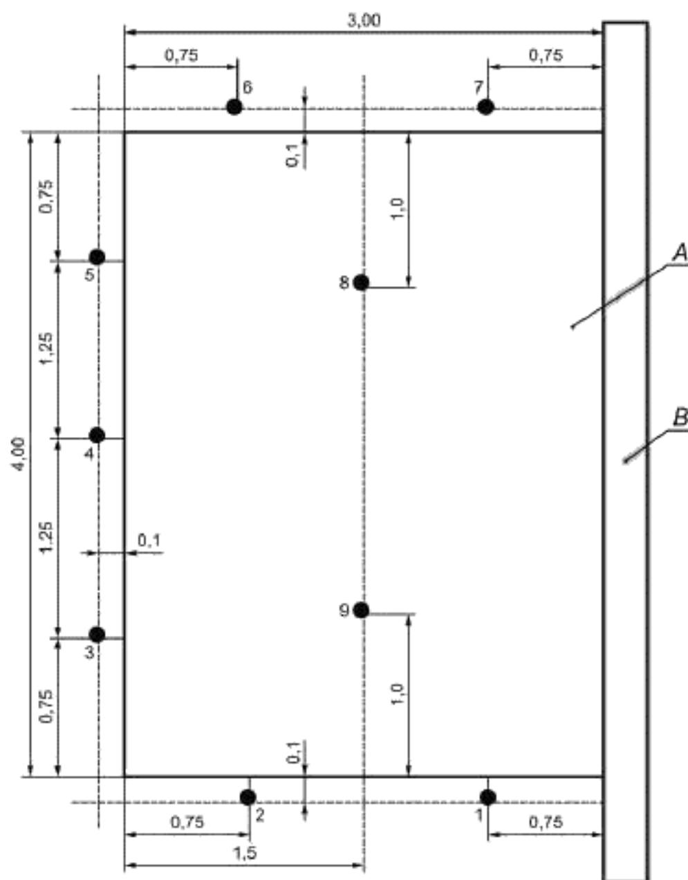
*A* — испытуемый образец, *B* — стена печи
