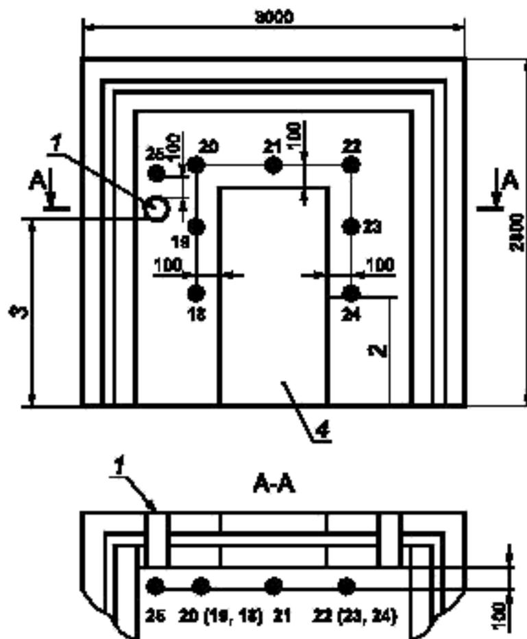
Рисунок 2 — Конструкция и точки измерений (18—25) в комнатах данных
