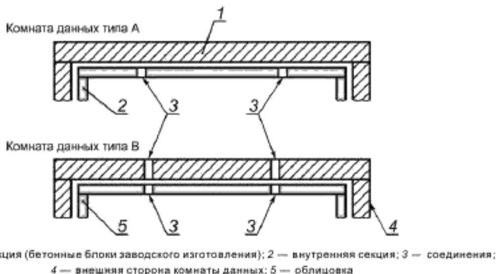
Рисунок 1 — Расположение комнаты данных при проведении испытаний (горизонтальное сечение)
