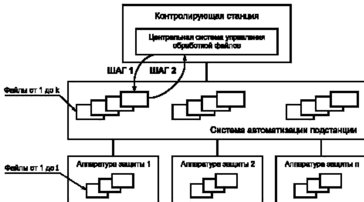
Рисунок 99 — Запрос от системы автоматизации подстанции
