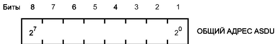
Рисунок 7 — ОБЩИЙ АДРЕС ASDU (один байт)
