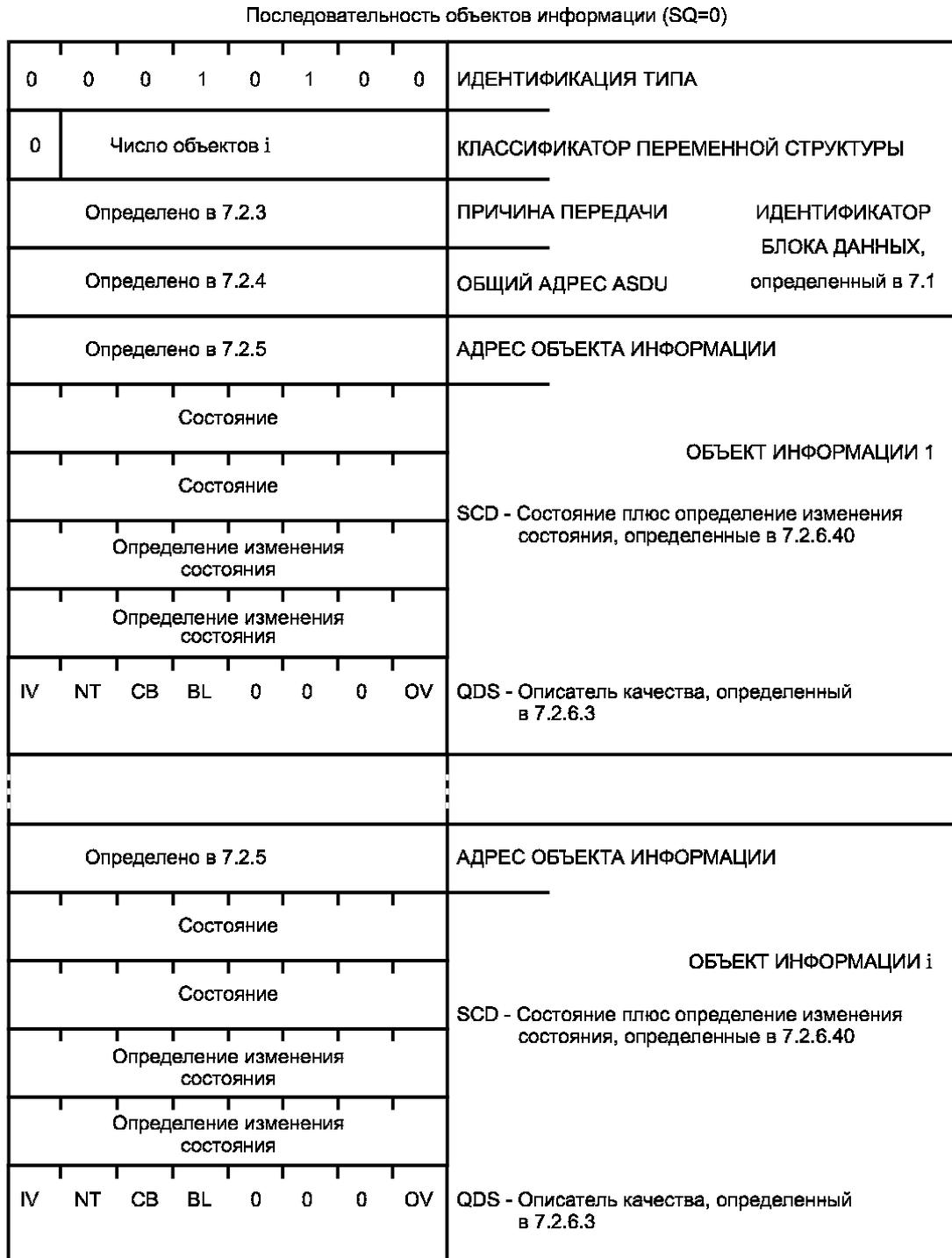
Рисунок 35 — ASDU. M\_PS\_NA\_1. Упакованная одноэлементная информация с определением изменения состояния
