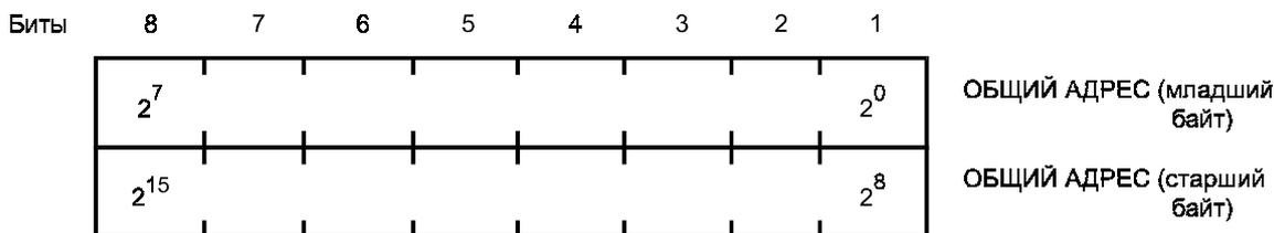
Рисунок 8 — ОБЩИЙ АДРЕС ASDU (два байта)
