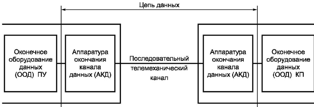
Рисунок 2 — Интерфейсы и соединения между ПУ и КП
