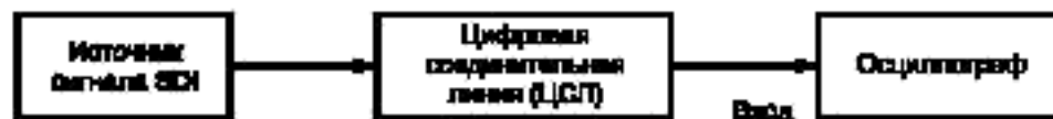
Рисунок 1 — Схема измерений размаха сигнала, уровня постоянной составляющей, времени нарастания и спада импульсов и выбросов переходного процесса при нарастании и спаде импульсов
