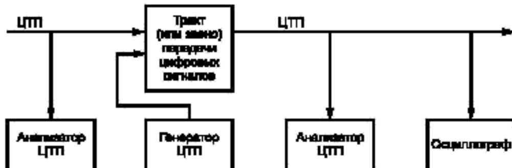
Рисунок 2 — Схема проведения измерений параметров цифрового транспортного потока
