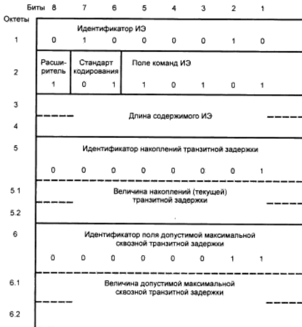
Рисунок 14 — Формат ИЭ «Сквозная транзитная задержка»
