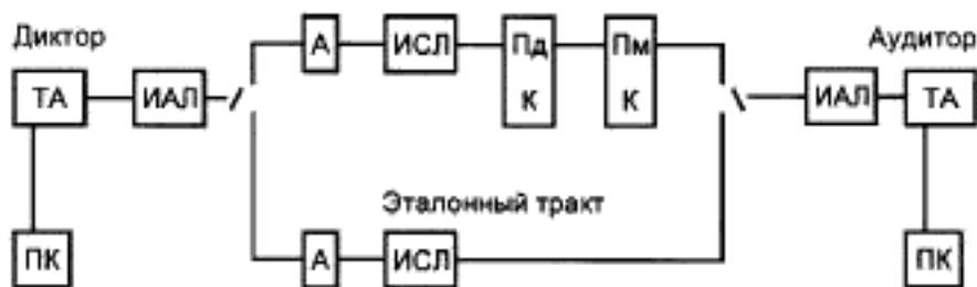
ТА — телефонный аппарат; ИАЛ — искусственная абонентская линия; ПК — питающий комплект; А — аттенюатор; ИСЛ — искусственная соединительная линия; Пд К — передающая часть оцениваемого кодека; Пм К — приемная часть оцениваемого кодека.
