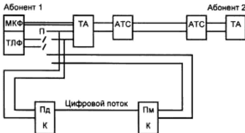
МКФ — микрофон микротелефонной трубки телефонного аппарата; ТЛФ — телефон микротелефонной трубки телефонного аппарата; П — переключатель; ТА — телефонный аппарат; АТС — автоматическая телефонная станция; Пд К — передающая часть оцениваемого кодека; Пм К — приемная часть оцениваемого кодека.
