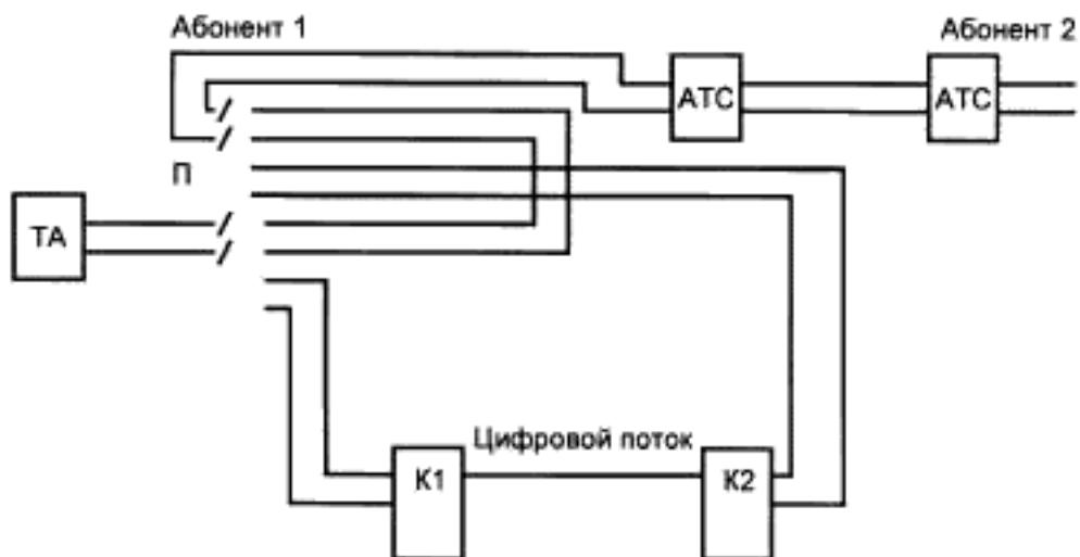
П — переключатель; ТА — телефонный аппарат; АТС — автоматическая телефонная станция; К 1(2) — оцениваемый кодек 1(2).
