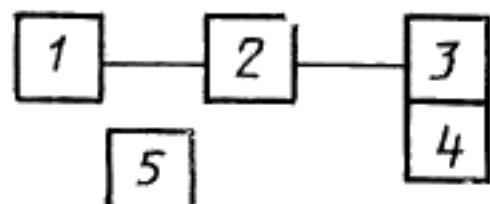
1 — лазер; 2 — оптическое устройство; 3 — пластина; 4 — столик; 5 — средство юстировки
