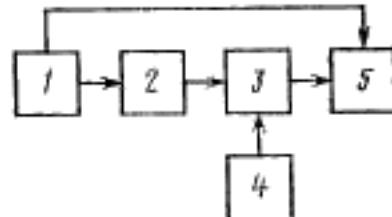
1—источник импульсов оптического излучения на основе лазера; 2—ослабитель; 3—камера с исследуемым ФЭУ и делителем напряжения питания; 4—источник питания ФЭУ; 5—стробоскопический осциллограф.
