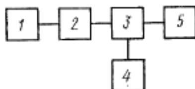
1—стабилизированный источник оптического излучения; 2—измерительный ослабитель, 3—камера с исследуемым ФЭУ и датчиком напряжения питания; 4—стабилизированный источник питания ФЭУ; 5—устройство для регистрации зважений анодового фототока.
