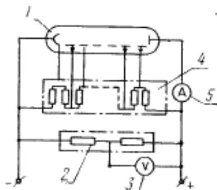
1—исследуемый ФЭУ; 2—делитель напряжения вольтметра; 3—вольтметр; 4—делитель напряжения ФЭУ; 5—амперметр.
