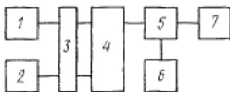
1, 2—источники постоянного оптического излучения; 3—измерительный ослабитель; 4—оптический смеситель; 5—камера с исследуемым ФЭУ, делителем напряжения питания и резистором анодной нагрузки; 6—источник питания ФЭУ; 7—вольтметр постоянного тока.
