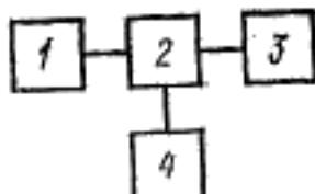
1—источник оптического излучения на основе светодиода; 2—камера с ФЭУ и делителем напряжения; 3—вольтметр или осциллограф; 4—источник питания ФЭУ.
