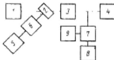
1—источник импульсов оптического излучения на основе лазера; 2—делительная пластина; 3—измерительные ослабители; 4—СИ ММ с известными параметрами; 5—контрольное средство измерений; 7—камера с исследуемым фотоэлементом; 8—источник питания фотоэлемента; 9—импульсный вольтметр или осциллограф
