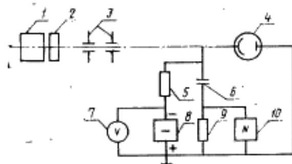
1—источник импульсов оптического излучения; 2—измерительный ослабитель; 3—диафрагма; 4—неследующий фотозлемент; 5—резистор развязки; 6—накопительный конденсатор; 7—вольтметр; 8—источник питания фотозлемента; 9—резистор нагрузки; 10—импульсный вольтметр или осциллограф.
