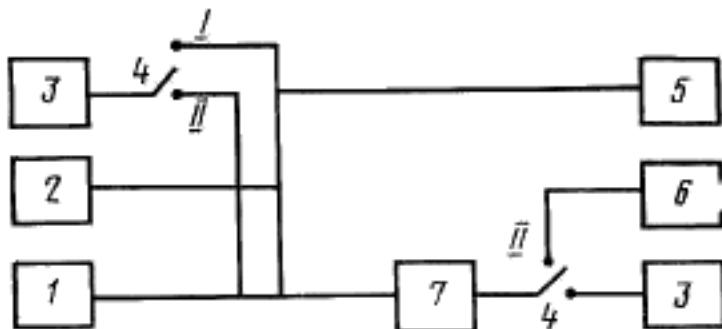
1—электронно-счетный частотомер; 2—формирователь одиночных импульсов; 3—вольтметр; 4—тумблер; 5—источник питания; 6—потенциометр; 7—исследуемый преобразователь с системой терmostатирования
