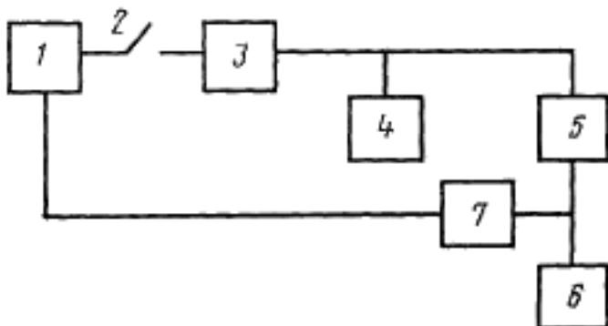
1—источник питания постоянного тока; 2—ключ; 3—магазин сопротивлений; 4—цифровой вольтметр; 5—неизвестный преобразователь с системой терmostатирования; 6—потенциометр постоянного тока с усилителем; 7—катушка электрического сопротивления
