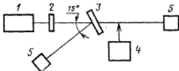
1—блок лазера для измерений на длинах волн 0,6; 0,63 и 10,6 мкм, скомбинированного с юстировочным лазером; 2—дифракционная решетка; 3—делительная пластина; 4—исследуемый преобразователь с системами регистрации и терmostатирования; 5—контрольное средство измерений средней мощности
