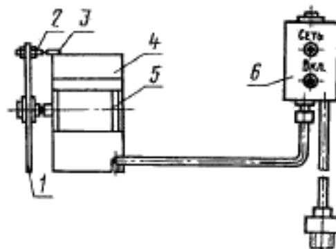
1—вращающийся диск; 2—штырек; 3—микропереключатель; 4—корпус затвора; 5—двигатель; 6—пульт управления
