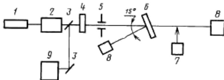
1—юстировочный лазер для измерений на длинах волн 0,69 и 1,06 мкм; 2—лазер для измерений на длинах волн 0,69; 1,06; 10,6 мкм; 3—зеркало; 4—механический затвор для измерений на длине волн 10,6 мкм; 5—диафрагма; 6—делительная пластина; 7—исследуемый преобразователь с системами регистрации и терmostатирования; 8—контрольное средство измерений энергии одиночных импульсов; 9—юстировочный лазер для измерений на длине волны 10,6 мкм
