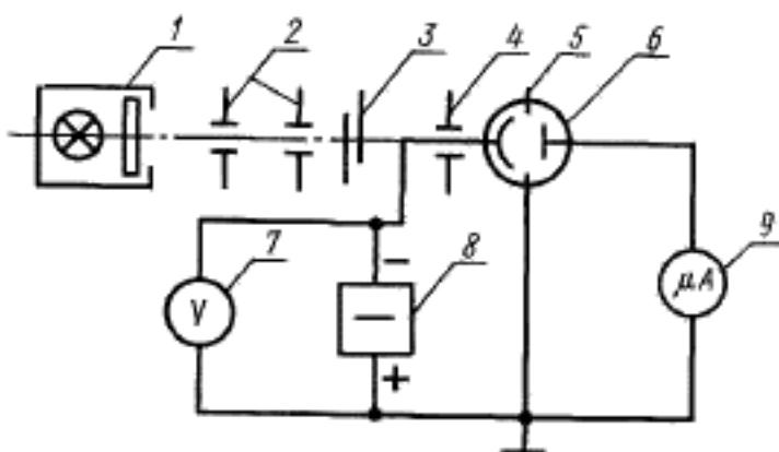
1—источник света типа А с устройством для ослабления светового потока; 2—светозащитные диафрагмы; 3—затвор; 4—диафрагма с калиброванным отверстием; 5—оконное кольцо фотодиода; 6—фотодиод; 7—вольтметр; 8—источник питания фотодиода; 9—микроамперметр.
