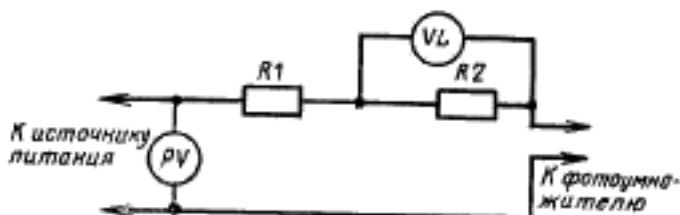
*PV* — вольтметр; *R<sub>1</sub>*, *R<sub>2</sub>* — резисторы по ГОСТ 7113—77; *VL* — неоновая лампа.
