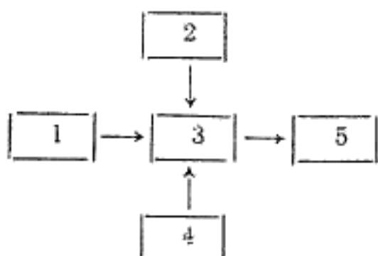
1—источник света с ослабителями светового потока, источником питания и вольтметром контроля режима работы; 2—вольтметр измерения напряжения запирания; 3—светонепроницаемая камера с фотоумножителем; 4—источник питания фотоумножителя с делителем напряжения (или отдельные источники питания электродов) с вольтметром контроля режима работы; 5—амперметр
