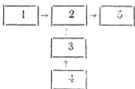
1—источник света с ослабителем светового потока, источником питания и вольтметром контроля режима работы; 2—светонепроницаемая камера с фотоумножителем и делителем напряжения; 3—высоковольтный выключатель; 4—источник питания фотоумножителя с вольтметром контроля режима работы; 5—регистрирующее устройство
