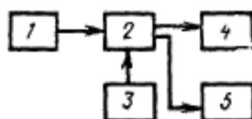
1 — источник света с ослабителями светового потока и вольтметром контроля режима работы; 2 — светонепроницаемая камера с фотоумножителем; 3 — источник питания фотоумножителя с делителем напряжения (или отдельные источники питания электродов) и вольтметром контроля режима работы; 4 — устройство регистрации тока анода; 5 — амперметр.
