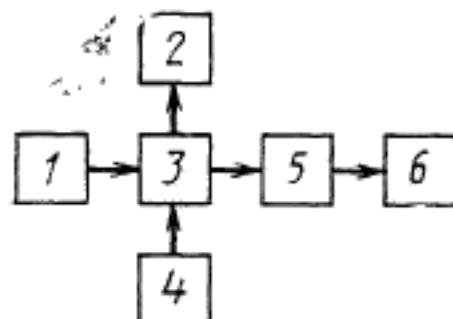
1—источник фонового потока с ослабителями светового потока, блоком питания и вольтметром контроля режима работы; 2—амперметр; 3—светонепроницаемая камера с фотоумножителем и резистором анодной нагрузки; 4—источник питания фотоумножителя с делителем напряжения (или отдельные источники питания электродов) и вольтметром контроля режима питания фотоумножителя; 5—широкополосный или узкополосный усилитель переменного напряжения; 6—вольтметр переменного тока
