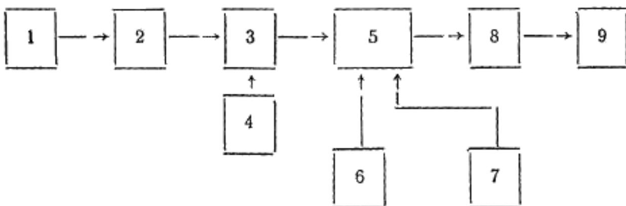
1—источник света А с ослабителями светового потока, блоком питания и вольтметром контроля режима работы; 2—модулятор светового потока; 3—оптический смеситель; 4—источник фонового светового потока с ослабителями светового потока; 5—светонепроницаемая камера с ФЭУ; 6—источник питания ФЭУ с делителем напряжения (или отдельные источники питания электродов) и вольтметром контроля режима ФЭУ; 7—амперметр; 8—узкополосный усилитель переменного напряжения; 9—вольтметр переменного тока.
