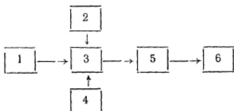
1—источник фонового светового потока с ослабителями светового потока, блоком питания и вольтметром контроля режима работы; 2—амперметр; 3—светонепроницаемая камера с ФЭУ и резистором анодной нагрузки; 4—источник питания ФЭУ с делителем напряжения (или отдельные источники питания электродов) и вольтметром контроля режима ФЭУ; 5—широкополосный или узкополосный усилитель переменного напряжения; 6—вольтметр переменного тока.
