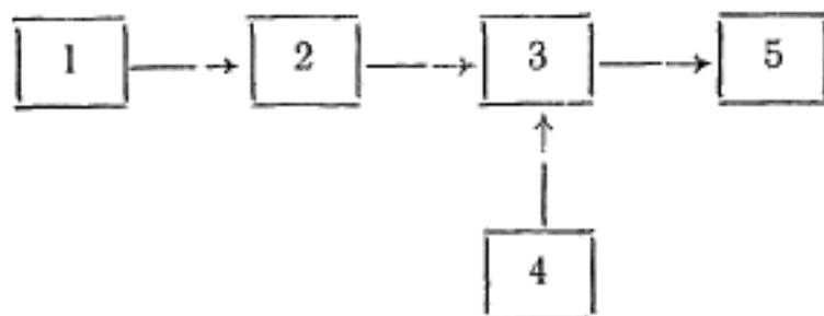
1—источник света с ослабителями светового потока, источником питания и вольтметром контроля режима работы; 2—устройство для изменения положения светового пятна на фотокатод; 3—светонепроницаемая камера с фотоумножителем и делителем напряжения; 4—источник питания фотоумножителя (или отдельные источники питания электродов) и вольтметр контроля режима работы; 5—амперметр
