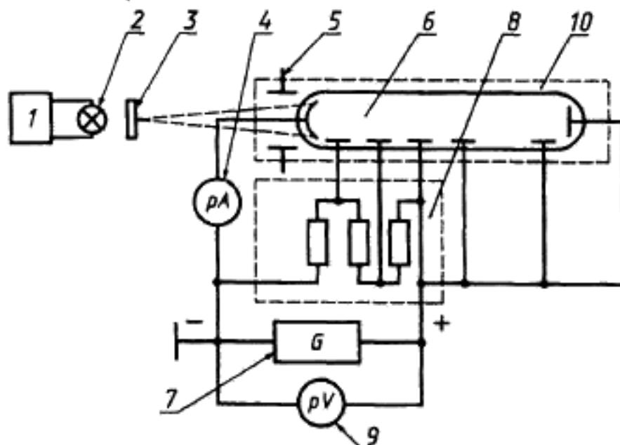
1 — блок питания и контроля режима источника света А; 2 — источник света А; 3 — ослабители светового потока; 4 — амперметр; 5 — диафрагма; 6 — фотоумножитель; 7 — источник напряжения G; 8 — делитель напряжения; 9 — вольтметр; 10 — светопроницаемая камера
