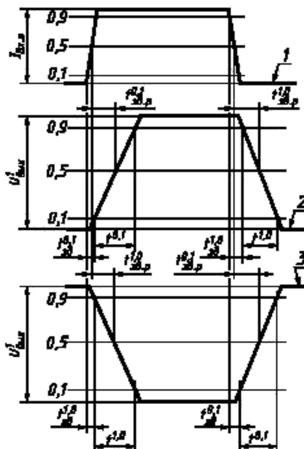
*I* – входной импульс, *2* – выходной импульс; *3* – выходной импульс при инвертирующей микросхеме;
