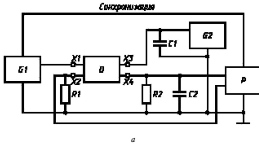
Схема включения транзисторной оптопары
