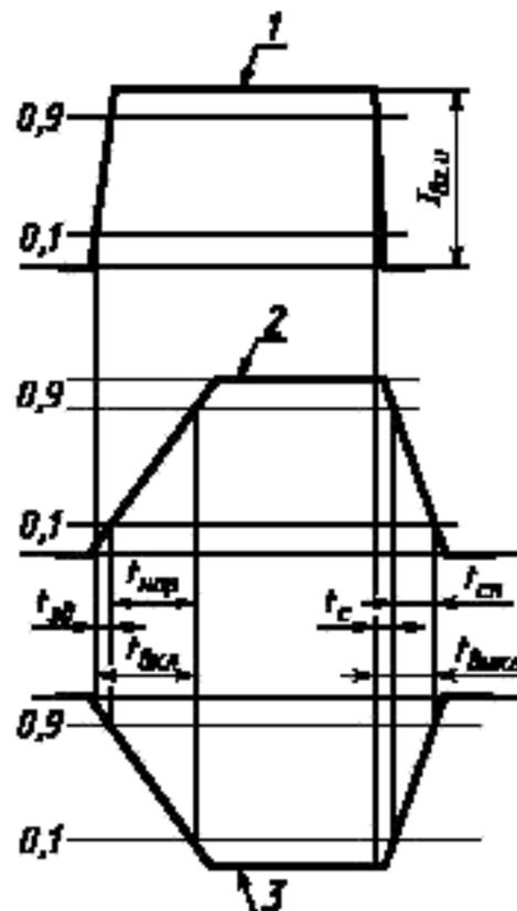
1 — входной импульс; 2, 3 — выходной импульс
