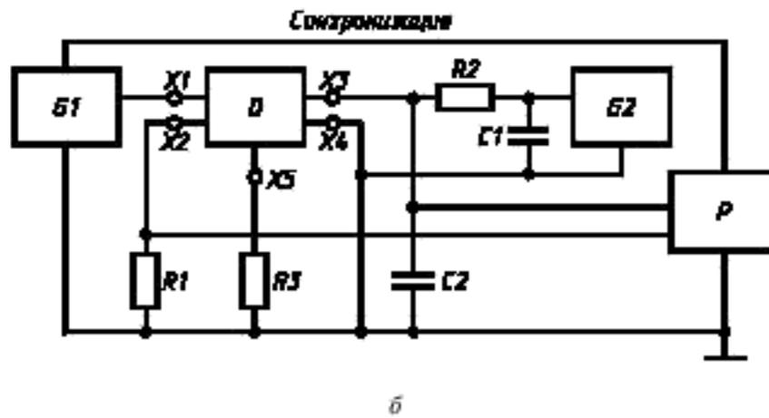
Схема включения транзисторной оптопары
