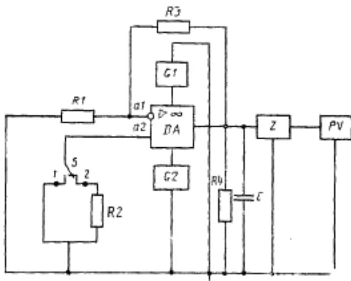
DA—проверяемый ОУ;  $G1$ ,  $G2$ —источники постоянного напряжения;  $Z$ —полосовой фильтр;  $PV$ —измеритель переменного напряжения;  $R1$ ,  $R3$ —резисторы обратной связи;  $R2$ —резистор, имитирующий сопротивление источника шума;  $R4$ —резистор нагрузки;  $C$ —конденсатор нагрузки;  $S$ —устройство коммутации;  $a1$ —инвертирующий вход ОУ;  $a2$ —неинвертирующий вход ОУ
