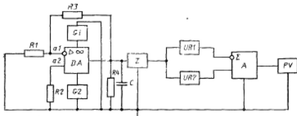
$DA$ —проверяемый ОУ;  $A$ —сумматор;  $G1$ ,  $G2$ —источники постоянного напряжения;  $R1$ ,  $R2$ —резисторы обратной связи;  $R3$ —резистор, имитирующий сопротивление источника шума;  $R4$ —резистор нагрузки;  $C$ —конденсатор нагрузки;  $UR1$ ,  $UR2$ —пиковые детекторы положительной и отрицательной полярности;  $Z$ —полосовой фильтр;  $a1$ —инвертирующий вход ОУ;  $a2$ —неинвертирующий вход ОУ
