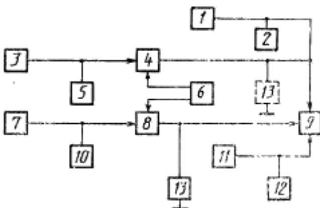
1 — источник питания напряжения смещения анодов индикатора; 2, 5, 10, 12 — вольтметры; 3, 7 — источники питания постоянного напряжения; 4 — генератор импульсов напряжения подавления; 6 — устройство управления и синхронизации; 8 — генератор импульсов напряжения сканирования; 9 — измеряемый индикатор; 11 — источник питания панели управления анодов сканирования; 13 — осциллограф
