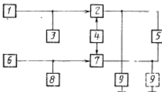
1 — источник питания генератора импульсов напряжения катодов; 2 — генератор импульсов напряжения катодов; 3, 8 — вольтметры; 4 — устройство управления и синхронизация; 5 — измеряющий индикатор; 6 — источник питания генератора импульсов напряжения анодов; 7 — генератор импульсов напряжения анодов; 9 — осциллограф
