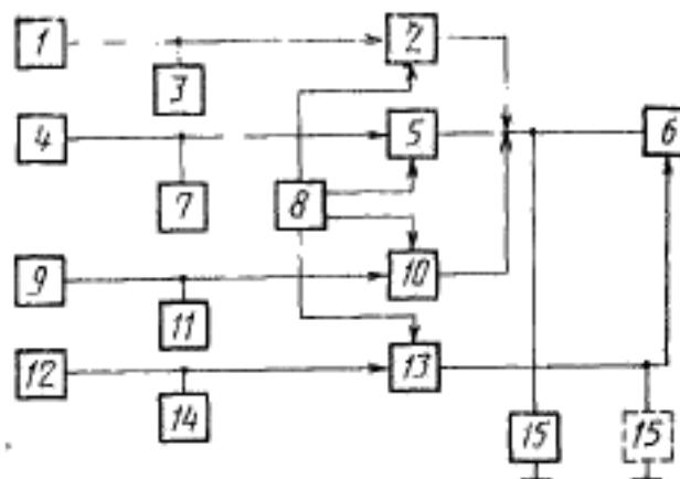
1, 4, 9, 12 — стабилизированные регулируемые источники питания; 2 — генератор импульсов опорного напряжения индикации; 3, 7, 11, 14 — полуметры; 5 — генератор импульсов напряжения записи; 6 — измеряемый индикатор; 6 — устройство управления и синхронизации; 10 — генератор импульсов напряжения стирания; 13 — генератор импульсов напряжения вспомогательного разряда; 15 — осциллограф
