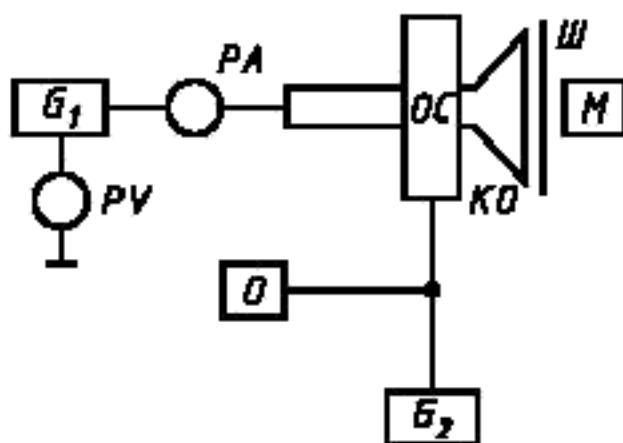
$G_1$  — источник питания КО;  $OC$  — отклоняющаяся система;  $M$  — микроскоп;  $G_2$  — блок развертки;  $PA$  — микроамперметр;  $PV$  — киловольтметр;  $KO$  — контрольный образец трубки;  $O$  — осциллограф;  $\mathcal{W}$  — шаблон
