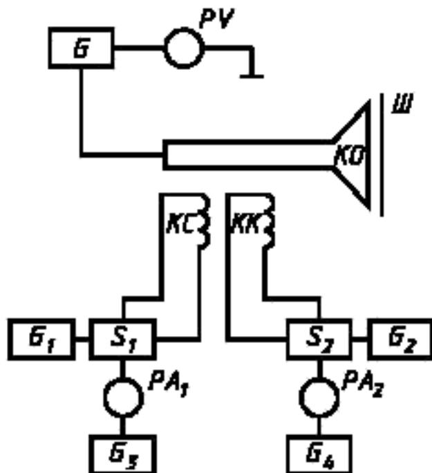
*KO* — контрольный образец трубы; *G* — источник питания *KO*; *G<sub>1</sub>*, *G<sub>2</sub>* — источники переменного тока; *G<sub>3</sub>*, *G<sub>4</sub>* — источники постоянного тока; *PA<sub>1</sub>*, *PA<sub>2</sub>* — амперметры постоянного тока; *PV* — киловольтметр; *KC* — строчная отклоняющая катушка ОС; *KK* — кадровая отклоняющая катушка ОС; *S<sub>1</sub>*, *S<sub>2</sub>* — коммутатор; *Ш* — шаблон
