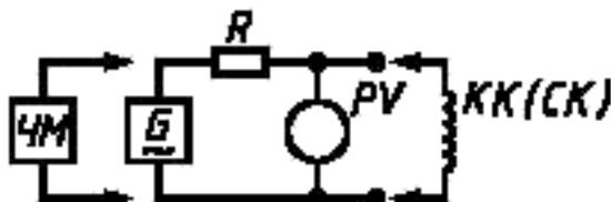
ЧМ — частотометр; Г — высокочастотный генератор синусоидальных сигналов; R — резистор; КК(СК) — кадровая (строчная) катушка отклонения; PV — киловольтметр
