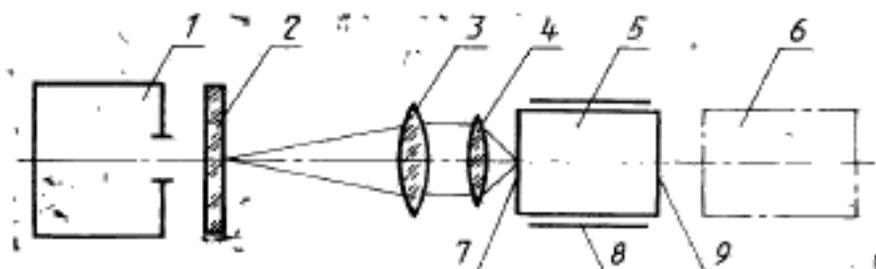
1—осветитель; 2—сетка; 3—коллимационный объектив; 4—проекционный объектив; 5—ЭОП; 6—иркомер; 7—фотокатод; 8—светонепроницаемая камера; 9—экран
