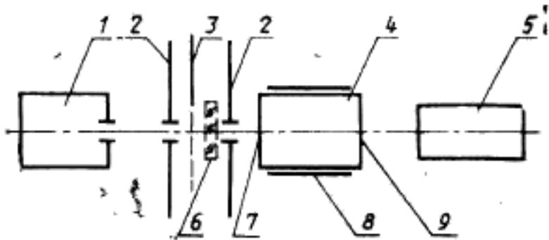
1—источник света; 2—светозащитная диафрагма; 3—заслонка; 4—ЭОП; 5—яркомер; 6—светофильтр; 7—фотокатод; 8—демодатель ЭОП; 9—экран
