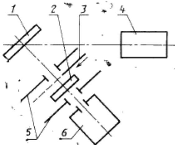
1—пластина диффузного рассеяния; 2—светофильтр; 3—заслонка; 4—яркомер; 5—светозащитная диафрагма; 6—источник света
