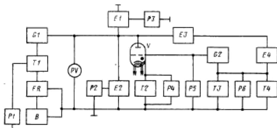
*B*—светящийся электрических импульсов; *E1*—устройство для измерения напряжения поддержания разряда; *E2*—делитель напряжения; *E3*—накопитель электрической энергии; *E4*—сопротивление нагрузки; *FR*—максимальное электрическое реле; *G1*—источник анодного напряжения; *G2*—источник напряжения сетки; *P1*—*P8*—осциллографы; *T1*—*T4*—измерительные трансформаторы тока или измерительные резисторы; *V*—испытываемый таситрон; *PV*—вольтметр
