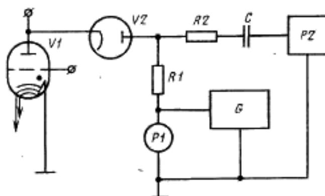
$G$ —источник напряжения;  $C$ —конденсатор;  $R_1$ ,  $R_2$ —резисторы;  $P_2$ —осциллограф;  $V_1$ —испытываемый таситрон;  $V_2$ —дюд;  $P_1$ —измеритель напряжения.
