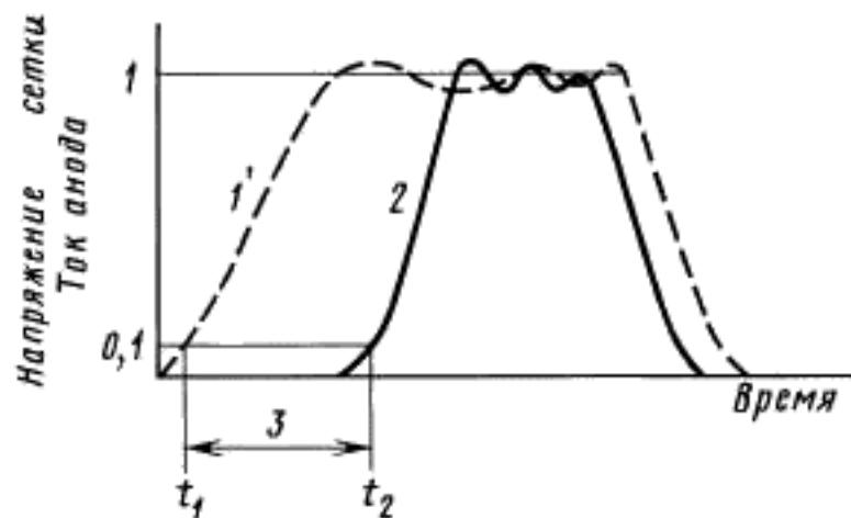
1 — импульс напряжения источника G2; 2 — импульс тока анода;
