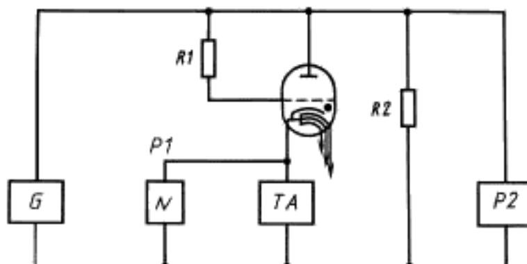
$R1, R2$  — резисторы;  $P1$  — осциллограф;  $G$  — источник анодного напряжения;
