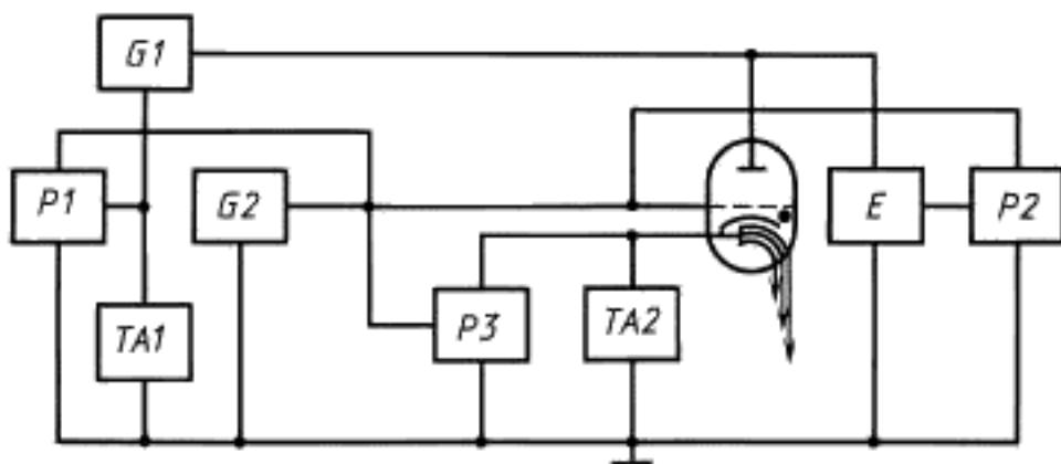
*P1, P2, P3 — устройства объективной оценки электроустойчивости (например осциллограф) или измерители временных интервалов; G1 — источник анодного напряжения; TA1, TA2 — трансформаторы тока для измерений или измерительные резисторы; G2 — источник управляющего напряжения; Е — делитель напряжения*
