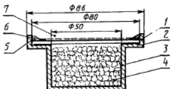
1 — испытуемый образец; 2 — слой битума;
