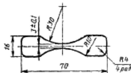
Рисунок 2 — Образец-лопатка типа 2
