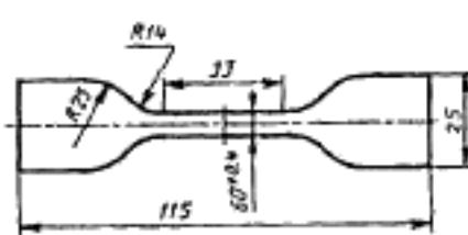
Рисунок 1 — Образец-лопатка типа 1
