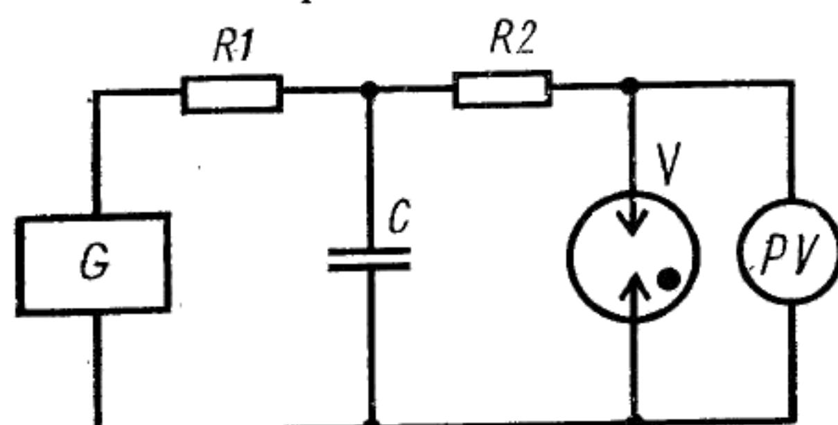
*R<sub>1</sub>, R<sub>2</sub>—резисторы; C—конденсатор; PV—измеритель напряжения; V—испытываемый разрядник; G—источник постоянного напряжения.*
