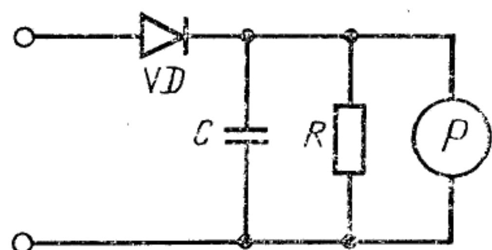
*C*—конденсатор; *P*—измеритель напряжения; *VD*—диод; *R*—резистор
