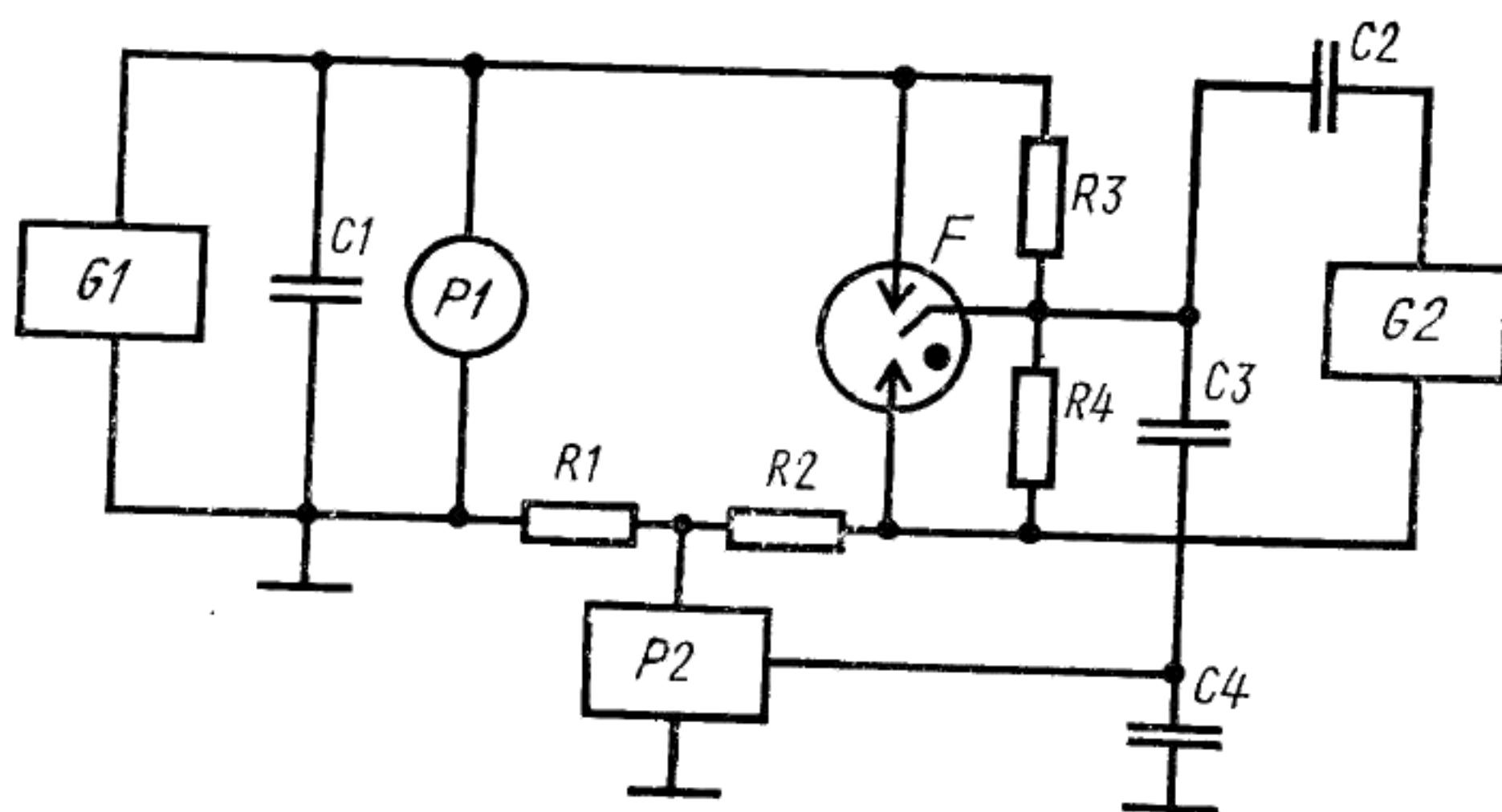
$R_1, R_2, R_3, R_4$ —резисторы;  $C_1, C_2, C_3, C_4$ —конденсаторы;  $P_1$ —измеритель напряжения;  $F$ —испытываемый разрядник;  $G_1$ —источник постоянного напряжения;  $P_2$ —счетчик пропусков и самопроизвольных пробоев;  $G_2$ —источник импульсного напряжения
