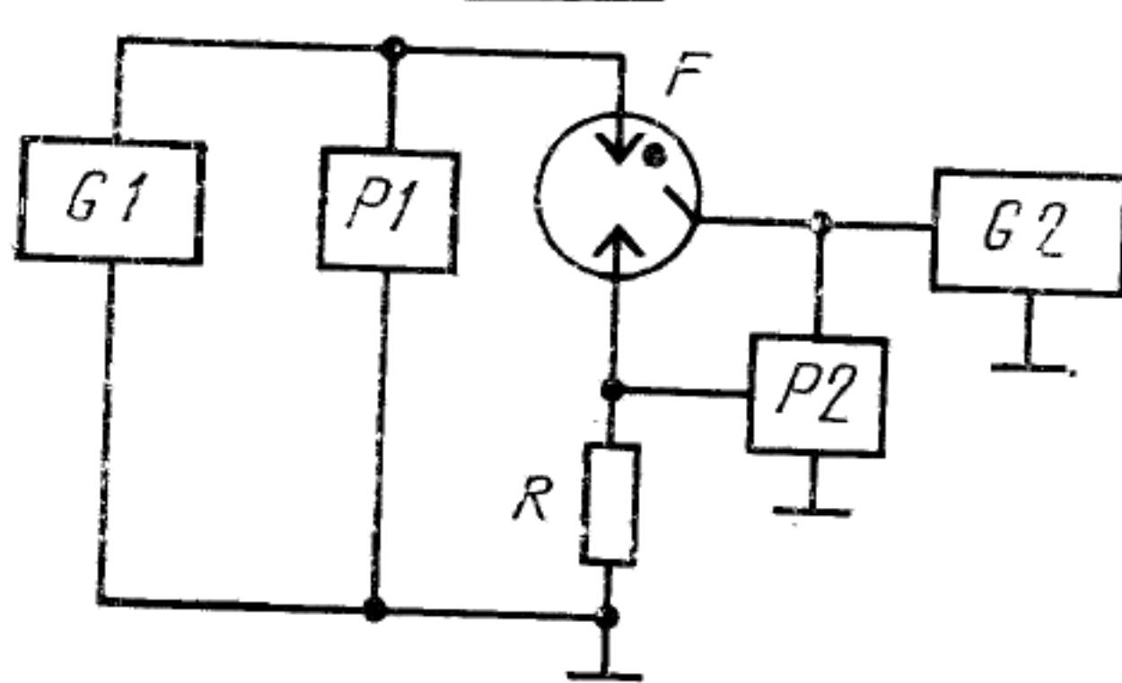
*G<sub>1</sub>*—источник постоянного напряжения; *P<sub>1</sub>*—измеритель напряжения; *F*—испытуемый разрядник; *G<sub>2</sub>*—источник импульсного напряжения; *P<sub>2</sub>*—двуухлучевой осциллограф; *R*—резистор
