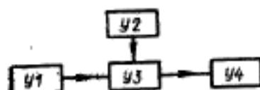
У1—генератор управляющих импульсов; У2—источник постоянного напряжения; У3—схема включения прибора; У4—фиксатор входных и выходных импульсов.
