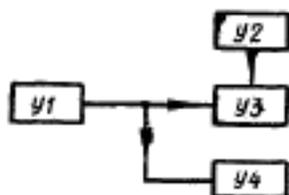
*U1*—генератор управляющих импульсов; *U2*—источник постоянного напряжения; *U3*—схема включения прибора; *U4*—осциллограф.
