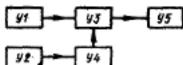
U1—генератор импульсов; U2—источник постоянного напряжения; U3—электронный ключ; U4—прибор; U5—пересчетное устройство.
