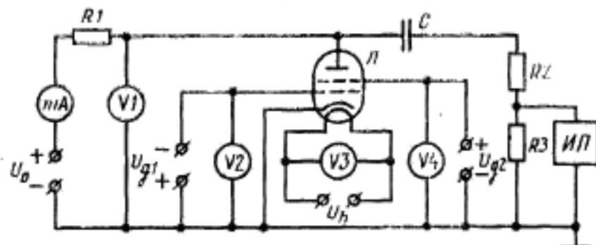
$R1$ —зарядный резистор;  $R2$ —ограничительный резистор;  $R3$ —измерительный резистор;  $C$ —накопительный конденсатор;  $mA$ —миллиамперметр;  $V1$ — $V4$ —вольтметры;  $ИП$ —счетчик искрений;  $L$ —испытываемая лампа
