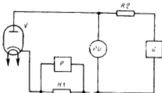
*G*—генератор импульсного напряжения; *P*—импульсный вольтметр (осциллограф); *P0*—импульсный вольтметр; *R1, R2*—резисторы; *V*—испытуемый кенотрон.
