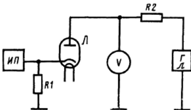
*L* — испытываемая лампа; *ИП* — импульсный вольтметр или осциллограф; *R<sub>1</sub>* — безындуктивный измерительный резистор; *R<sub>2</sub>* — безындуктивный ограничительный резистор; *V* — импульсный вольтметр; *Г* — генератор импульсов.
