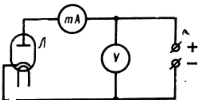
*mA* — миллиамперметр постоянного тока; *V* — вольтметр постоянного тока; *L* — испытуемый кенотрон.
