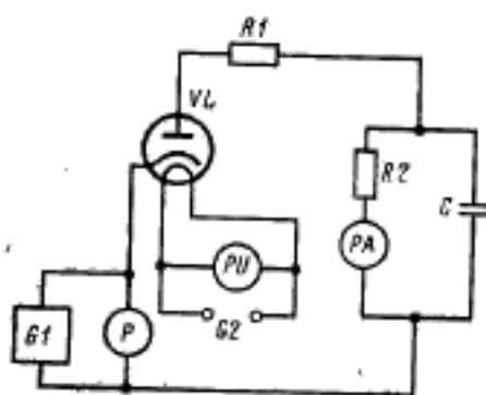
$C$  — конденсатор;  $GI$  — генератор отрицательных импульсов;  $G2$  — источник постоянного или переменного тока;  $PU$  — вольтметр постоянного или переменного тока;  $P$  — измерительное устройство;  $R1$ ,  $R2$  — резисторы;  $VL$  — испытуемый кенотрон;  $PA$  — миллиамперметр постоянного тока
