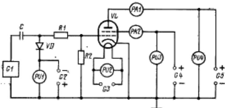
*C*—конденсатор; *G1*—генератор импульсов; *G2*, *G4*, *G5*—источники постоянного тока; *G3*—источник постоянного или переменного тока; *PM1*, *PM2*—милливольтметры постоянного тока; *PUV*, *PUV3*, *PUV4*—вольтметры постоянного тока; *PUV2*—вольтметр постоянного или переменного тока; *R1*, *R2*—резисторы; *VD*—полупроводниковый диод; *VL*—испытуемая лампа
