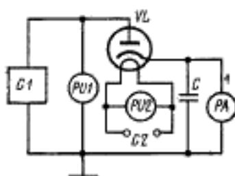
*C*—конденсатор; *GI*—генератор синусоидального напряжения; *R1*—источник постоянного или переменного тока; *PA*—миллиамперметр постоянного тока; *PUI*—вольтметр переменного тока; *PU2*—вольтметр постоянного или переменного тока; *VL*—испытуемая лампа
