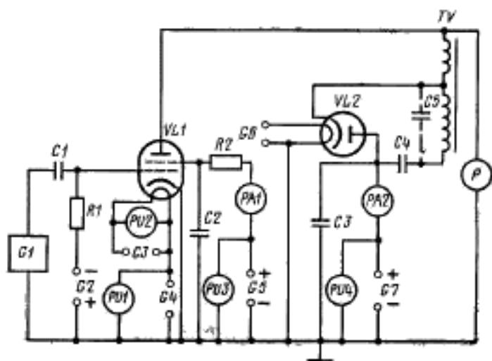
*C1—C5*—конденсаторы; *G1*—генератор отрицательных импульсов; *G2, G4, G5, G7*—источники постоянного тока; *G3, G6*—источники постоянного или переменного тока; *PA1, PA2*—миллиамперметры постоянного тока; *PUI, PU3, PU4*—вольтметры постоянного тока; *PV2*—вольтметр постоянного или переменного тока; *P*—устройство для измерения амплитуды напряжения анода в импульсе; *R1, R2*—резисторы; *TV*—импульсный трансформатор; *VU1*—испытуемая лампа; *VL2*—демпферный дроссель.
