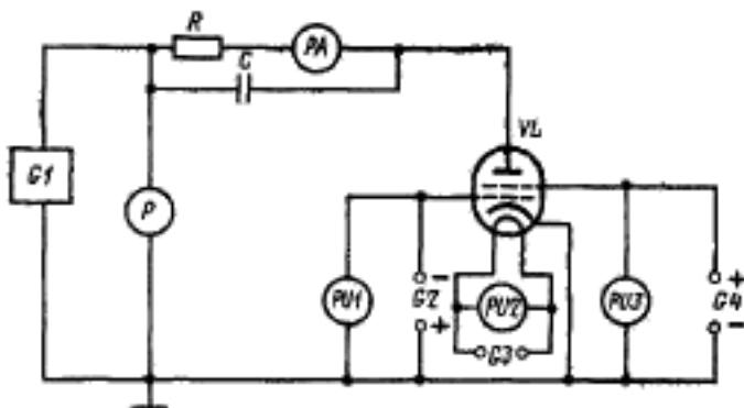
*C* — конденсатор; *GI* — генератор импульсов; *G2*, *G4* — источники постоянного тока; *G3* — источник постоянного или переменного тока; *P* — микромиллерметр постоянного тока; *P* — устройство для измерения импульсного напряжения; *PU1*, *PU3* — вольтметры постоянного тока; *PU2* — вольтметр постоянного или переменного тока; *R* — резистор; *VL* — испытуемая лампа
