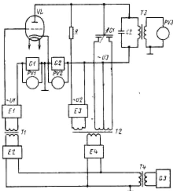
*E<sub>1</sub>, E<sub>3</sub>, E<sub>4</sub>—аттенюаторы; E<sub>2</sub>—делитель напряжения; VL—испытуемая лампа;
