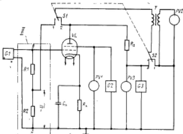
*G1*—генератор синусодального напряжения; *G2*, *G3*—источники постоянного напряжения; *S<sub>1</sub>*, *S<sub>2</sub>*—переключатели калибровки прибора *PV2*; *VL*—испытуемая лампа; *C<sub>x</sub>*—конденсатор; *R<sub>g</sub>*—резистор; *T*—трансформатор; *PV2*—милливольтметр; *PV1*, *PV3*—вольтметры; *R<sub>1</sub>*, *R<sub>2</sub>*—измерительные резисторы; *H*—одна из возможных схем делителя, предназначенного для калибровки прибора *PV2*.
