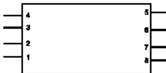
Рисунок А.3 — Пример обозначения выводов СЭМ
