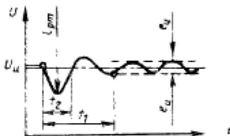
$U'_0$  — выходное установившееся напряжение;  $e_{\max}$  — максимальное начальное отклонение;  $e'_0$  — допустимое уставившееся отклонение;  $t_1$  — время регулирования напряжения;  $t_2$  — время длительности погоды.
