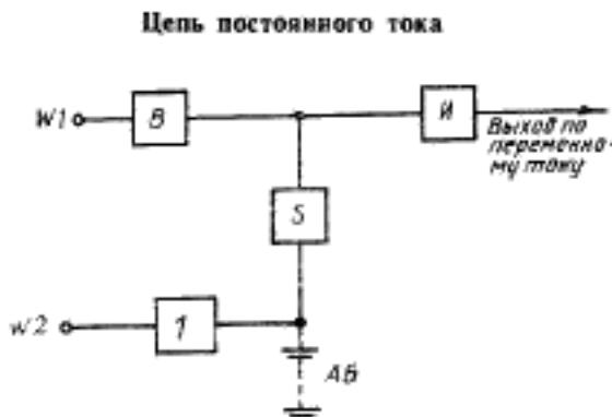
В—выпрямитель зарядки батареи;  $W1$ ,  $W2$ —входы по переменному току;  $S$ —блокирующий диод, тиристор или коммутирующее устройство
