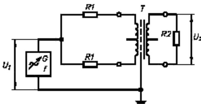
*T* — испытуемый трансформатор
