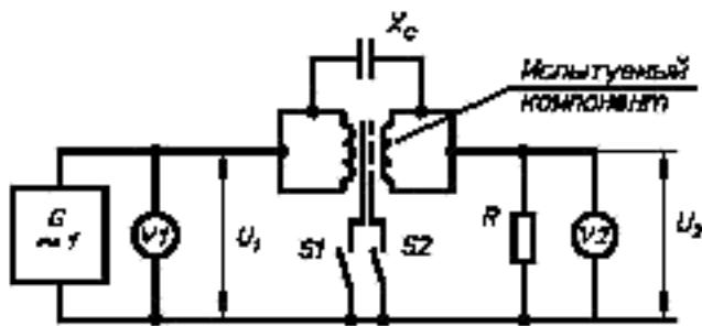
Рисунок 10 — Схема для определения межобмоточной емкости
