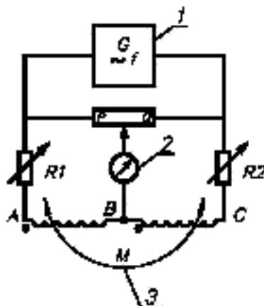
*P* и *Q* – лежащие элементы чисто омического сопротивления; *R<sub>1</sub>* и *R<sub>2</sub>* – переменные рефлекторы с чисто индуктивным сопротивлением; *I* – симметричный источник питания; *V* – детектор с высоким напряжением; 3 – испытуемый компонент
