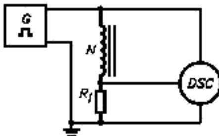
$R_f$  — прецизионный резистор с чисто омическим сопротивлением, выдающий падение напряжения не превышающее 1 % от  $I_{dmax}$
