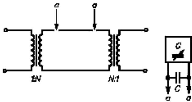
**П р и м е ч а н и е** — Конденсатор  $C$  должен иметь пренебрежимо малое реактивное сопротивление на испытательной частоте.
