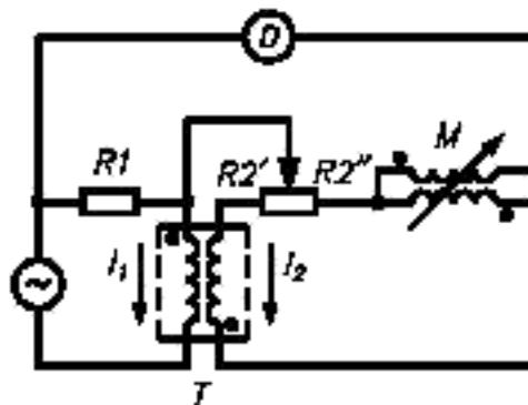
$T$  — испытуемый трансформатор тока;  $M$  — вариометр с регулируемой взаимной индуктивностью
