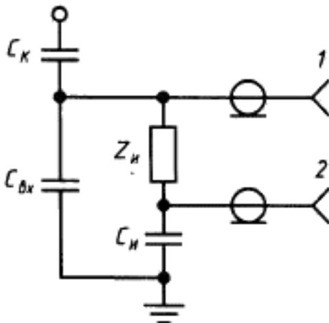
$C_k$  — емкость ввода или соединительного конденсатора;  $C_{bx}$  — емкость на входе измерительного устройства (суммарная емкость измерительной обкладки ввода и измерительного кабеля);  $Z_n$  — сопротивление измерительного элемента;  $C_n$  — емкость измерительного конденсатора; 1 — разъем для присоединения устройства измерений характеристик частичных разрядов; 2 — разъем для присоединения приборов, измеряющих испытательное напряжение
