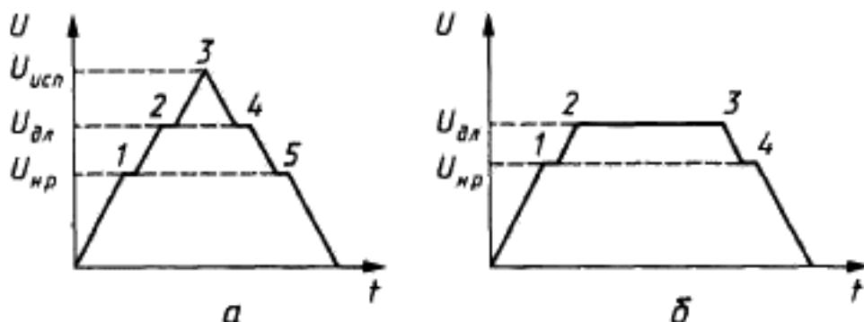
$U_{\text{исп}}$  — нормированное испытательное одноминутное напряжение;  $U_{\text{дл}}$  — нормированное испытательное длительное напряжение;  $U_{\text{раб}}$  — наибольшее рабочее напряжение
