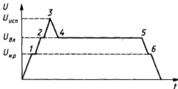
$U_{\text{исп}}$  — нормированное испытательное одноминутное напряжение;  $U_{\text{дл}}$  — нормированное испытательное длительное напряжение;  $U_{\text{раб}}$  — наибольшее рабочее напряжение
