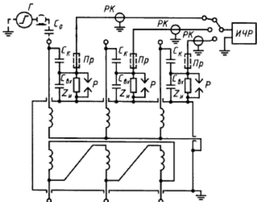
*IChP* — измерительный прибор (или комплект измерительных приборов);  $Z_n$  — сопротивление измерительного элемента;  $PK$  — измерительный кабель;  $C_k$  — емкость ввода или отдельного соединительного конденсатора;  $C_{bx}$  — емкость на входе измерительного устройства (суммарная емкость измерительной обкладки ввода и измерительного кабеля);  $C_0$  — емкость градуировочного конденсатора;  $G$  — градуировочный генератор;  $P$  — защитное устройство;  $P_r$  — предохранитель
