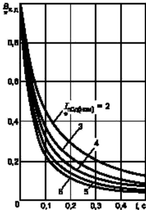
Рисунок 17 — Кривые для определения  $I_{т.эк}$  от асинхронного электродвигателя
