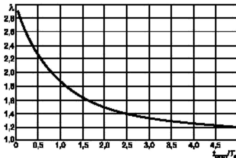
Рисунок В.1 — Зависимость коэффициента  $\lambda$  от  $t_{\text{откл}}/T_{\text{э}}$
