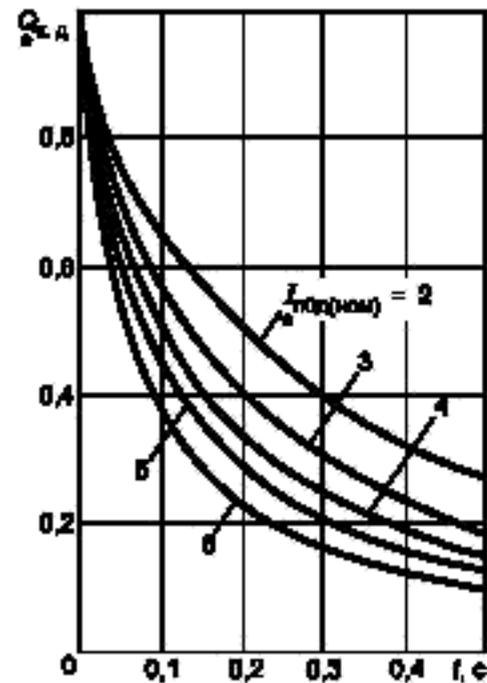
Рисунок 18 — Кривые для определения  $I_{т.эк}$  от асинхронного электродвигателя
