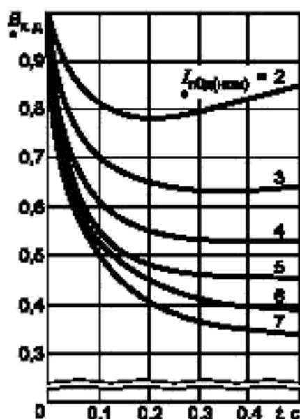
Рисунок 15 — Кривые для определения  $B_{к.д}$  от синхронного электродвигателя
