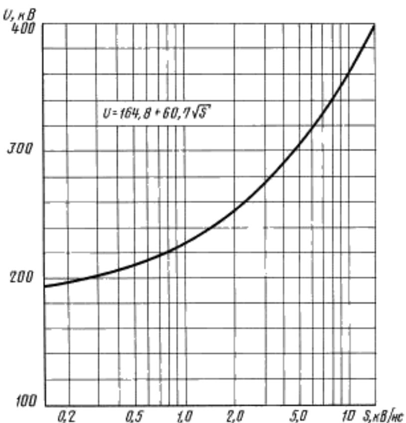
Вольт-секундная характеристика шарового измерительного разрядника с шарами диаметром 250 мм, расстоянием между шарами 60 мм при температуре 293 К (20 °C) и атмосферном давлении 101,3 кПа (1013 мбар или 760 мм рт. ст.). Полярность напряжения отрицательная
