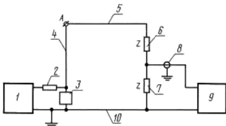
1 — источник напряжения; 2 — токоограничивающий резистор; 3 — коммутатор;
