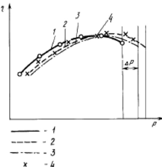
1 — кривая по требованиям технического задания; 2 — кривая по результатам измерений; 3 — кривая по измененным техническим требованиям; 4 — результат измерений
