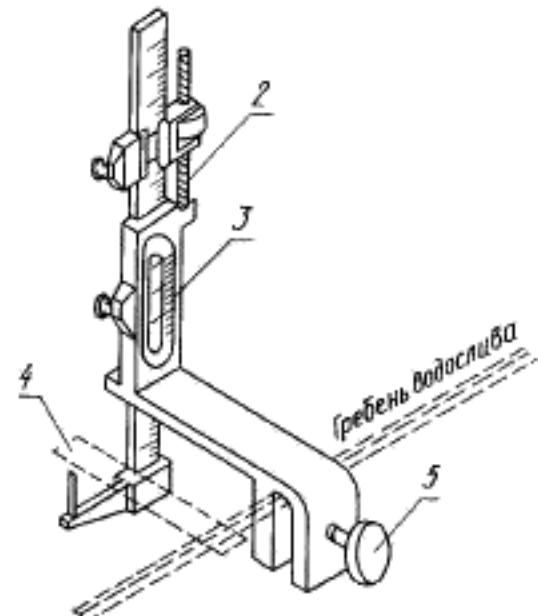
1 — точный уровень (нивелир); 2 — микрометрический винт; 3 — верньер с нониусом 0,05 мм;
