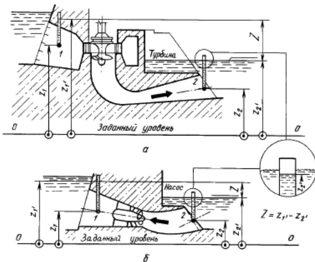
а — пропеллерная или поворотно-лопастная турбина;
