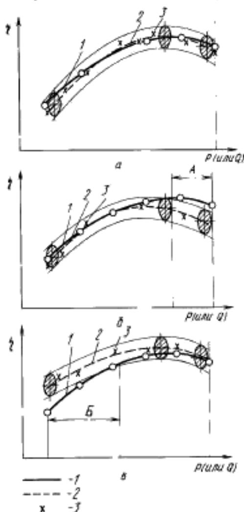
*a* — соответствие по КПД достигнуто; *б* — соответствие по КПД не достигнуто в зоне *A*, *в* — соответствие по КПД не достигнуто в зоне *B*.
