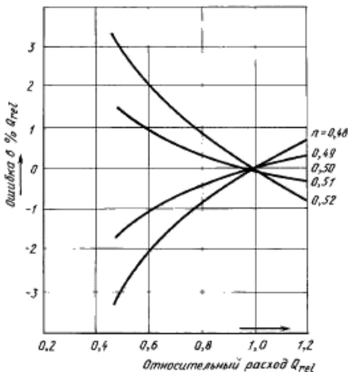
$$Q_i = kh^n, \text{ где } h \text{ — перепад давлений; } Q_{rel} = Q_i / Q_{i,rd}.$$
