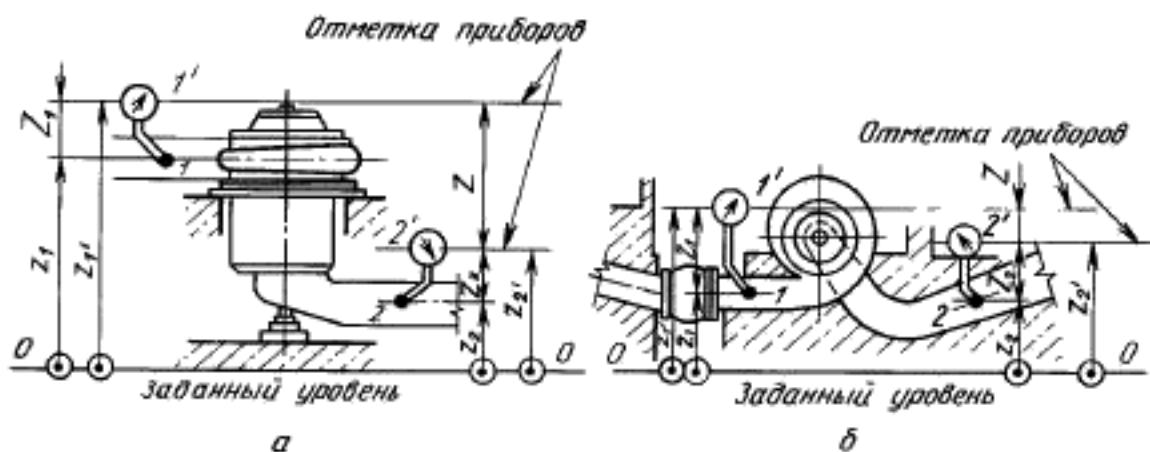
*a* — агрегат с вертикальным валом:  $Z_1 = z_1 - z_1'$ ; *б* — агрегат с горизонтальным валом:  $Z_2 = z_2 - z_2'$ .
