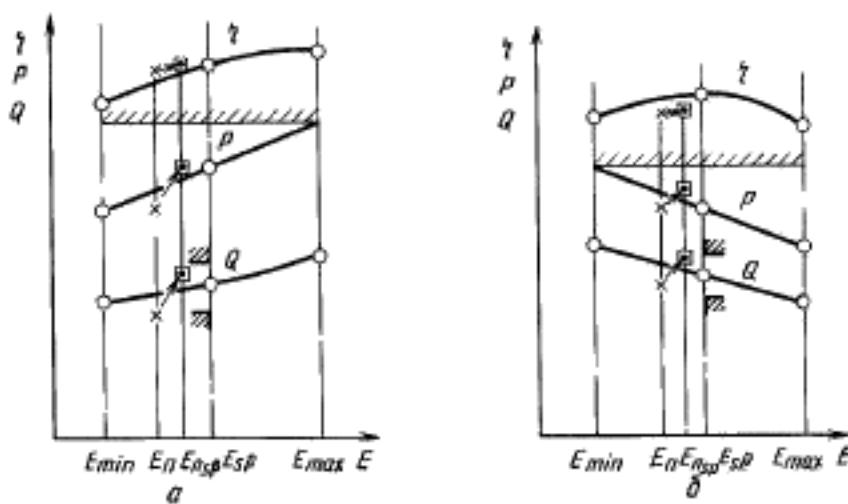
а — нерегулируемая турбина; б — насос;  $x$  — результат измерения;
