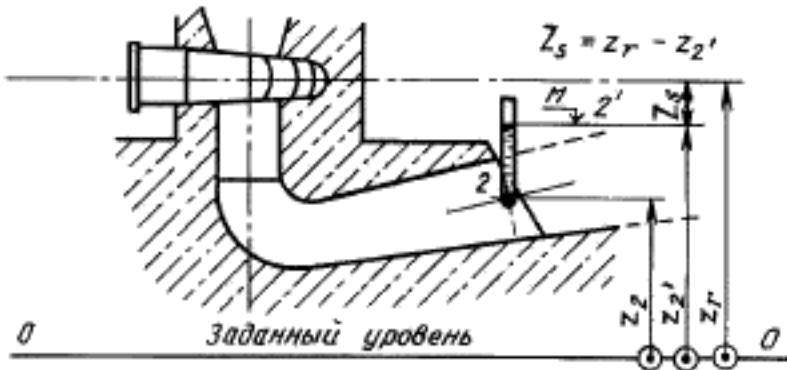
Пьезометр присоединен к точке 2'
