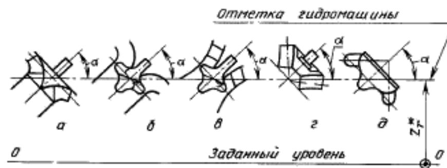
\* Отметка гидромашины  $\zeta$  не обязательно соответствует точке с максимальной кавитацией.
