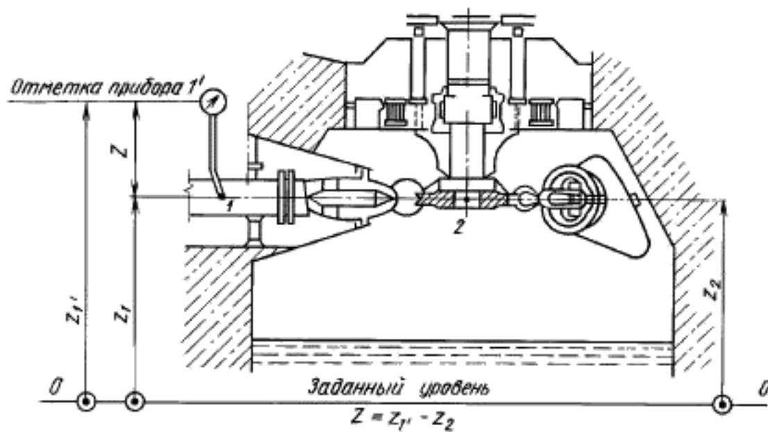
Когда давление в кожухе не подается, принимается, что контрольное сечение СНД соответствует плоскости на отметке  $z_2$ , а давление внутри кожуха равно атмосферному.
