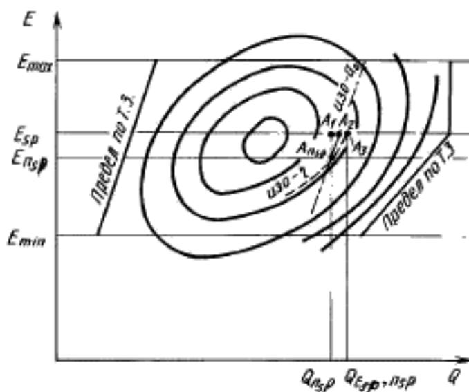
$A_{n_sp}$  —  $A_1$  для  $Q = \text{const}$ ;  $A_{n_sp}$  —  $A_2$  для  $a_0 = \text{const}$ ;  $A_{n_sp}$  —  $A_1$  для  $\eta = \text{const}$ ; изо- $a_0$  — линии равных открытий И.А.; изо- $\eta$  — линии равных КПД
