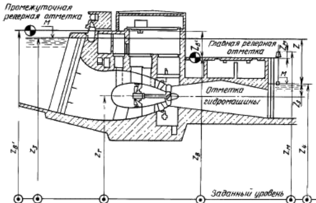
$z_r$  — отметка гидромашины;  $z_B$  — главная реперная отметка;  $z_{B'}$  — промежуточная реперная отметка;
