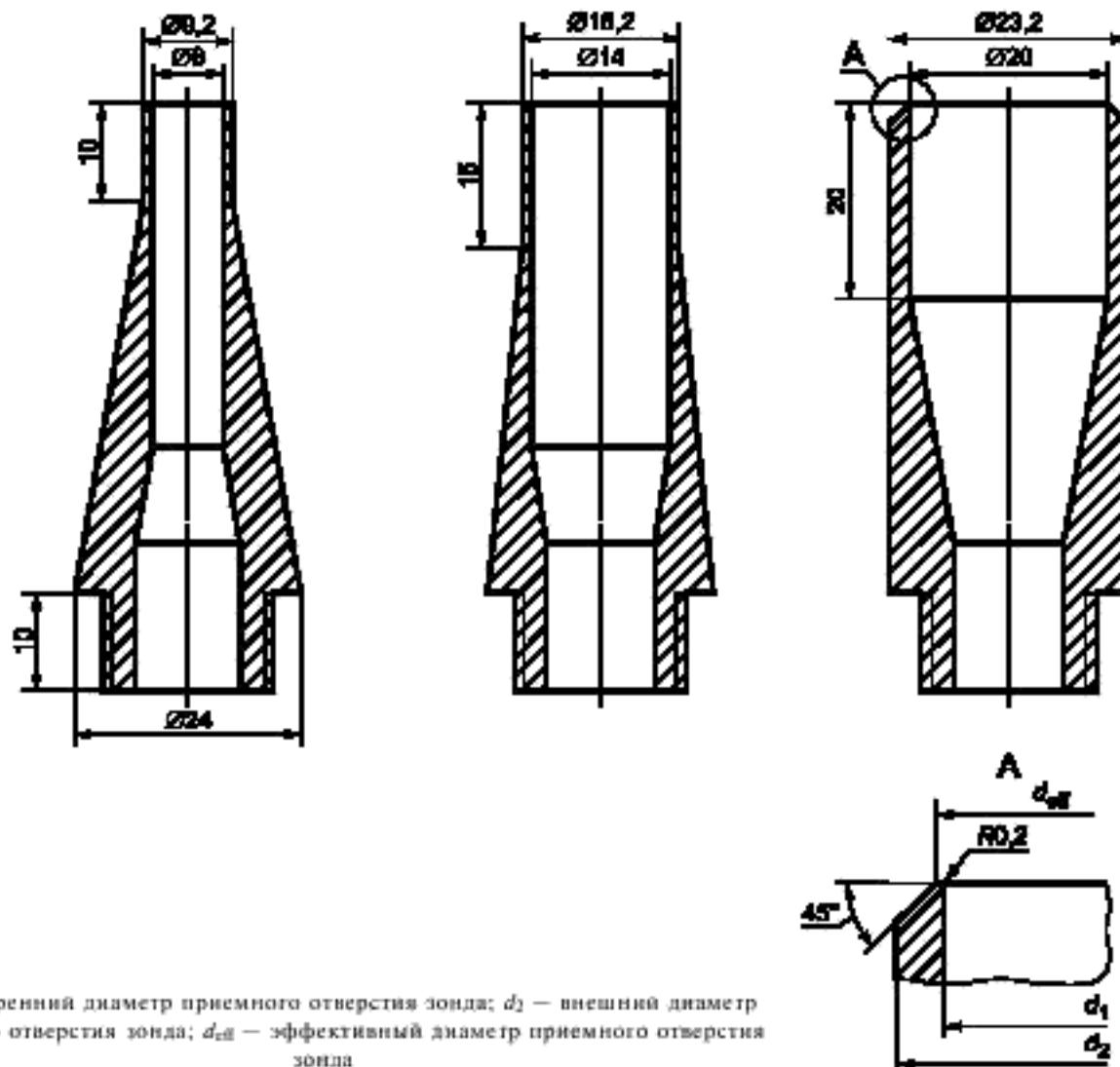
$d_1$  — внутренний диаметр приемного отверстия зонда;  $d_2$  — внешний диаметр приемного отверстия зонда;  $d_{\text{eff}}$  — эффективный диаметр приемного отверстия зонда
