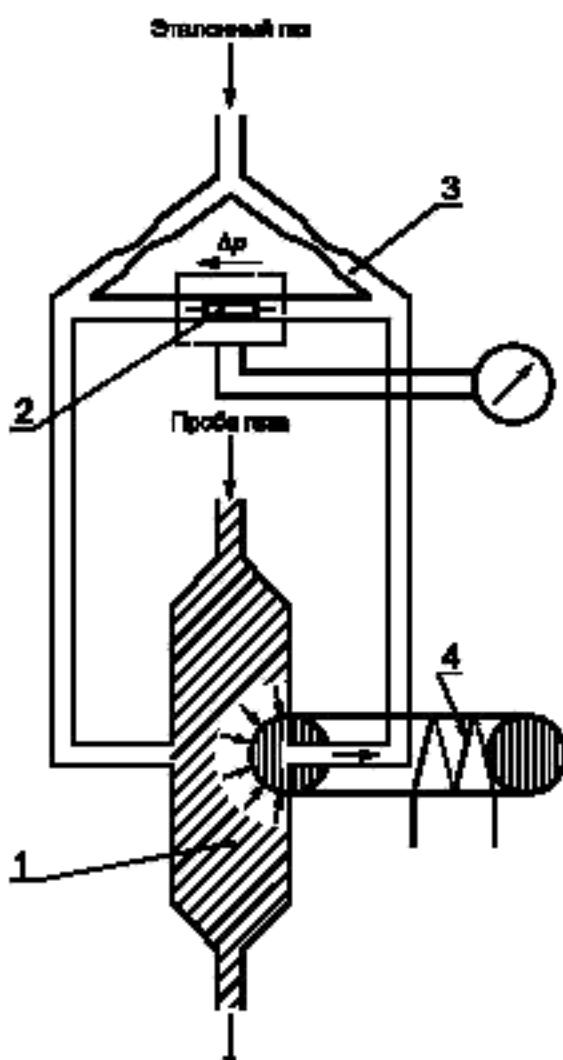
1 — камера измерений; 2 — микродатчик расхода;
