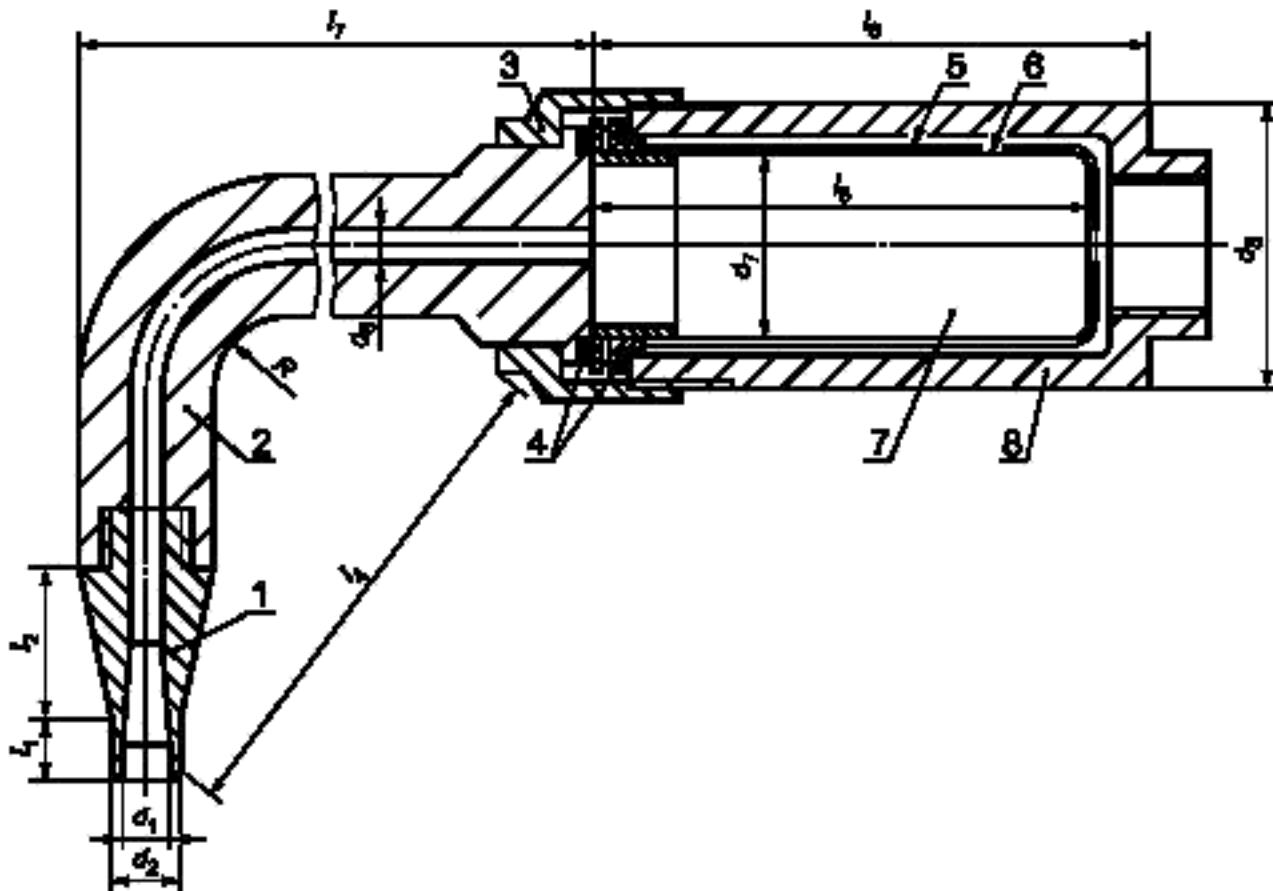
1 — пробоотборный зонд; 2 — колено; 3 — подсоединение сепаратора; 4 — уплотнение; 5 — корпус фильтра; 6 — патрон фильтра; 7 — изабивка фильтра (кварцевые нити); 8 — корпус сепаратора
