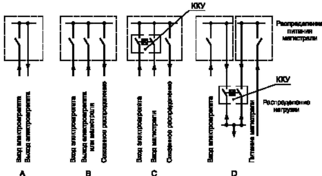
А — коммутационное устройство одиночного электроагрегата;
