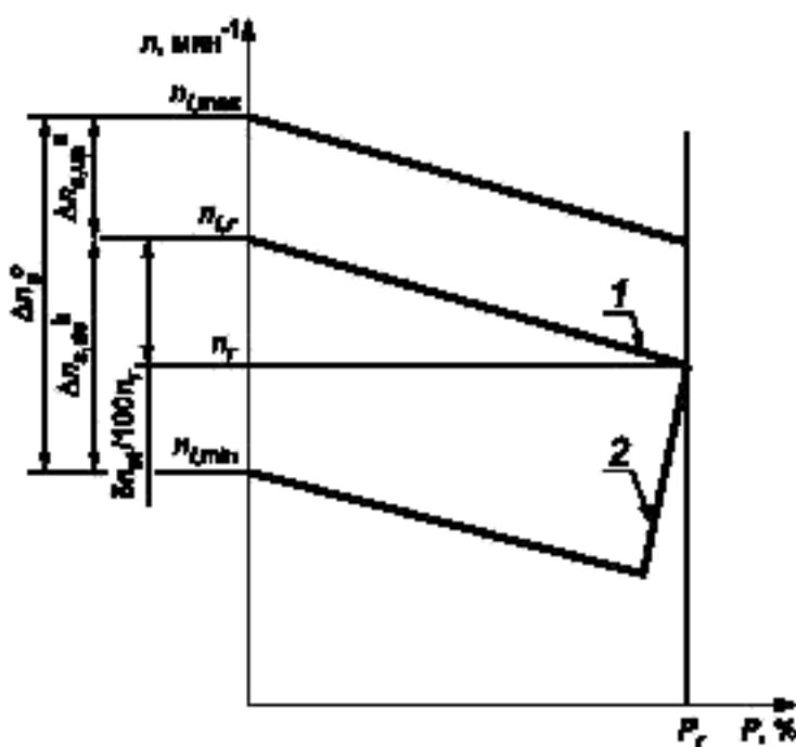
$P$  — мощность двигателя;  $n$  — частота вращения двигателя;  $a$  — верхний диапазон уставки частоты вращения;  $b$  — нижний диапазон уставки частоты вращения;  $c$  — диапазон уставки частоты вращения; 1 — характеристика частота вращения/мощность; 2 — предельное значение мощности
