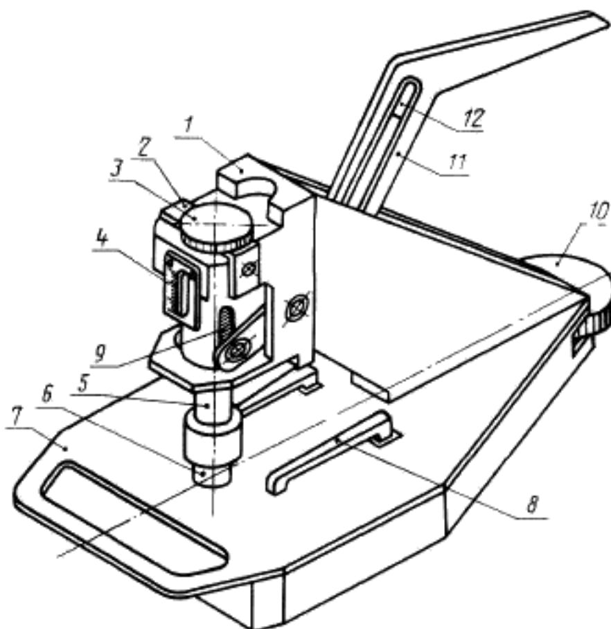
1 — корпус; 2 — скоба; 3 — регулировочный винт нагрузки; 4 — шкала; 5 — шток; 6 — резиновый пuhanсон; 7 — рабочий столик; 8 — зажимы образца; 9 — пружина; 10 — колесо регулировки зажимов; 11 — рукоятка; 12 — фиксатор рукоятки
